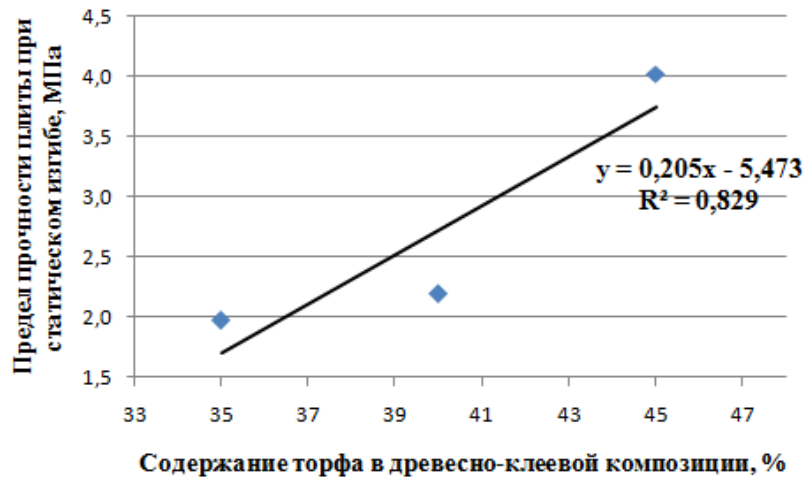
Рис. 3. Влияние содержание торфа в древесно-клеевой композиции на предел прочности плиты при статическом изгибе
